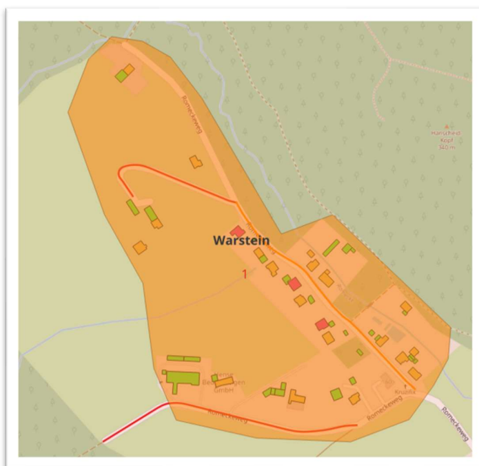
Abbildung 16: Beispiel der Gebäudeklassifizierung in Warstein Romecke 23
