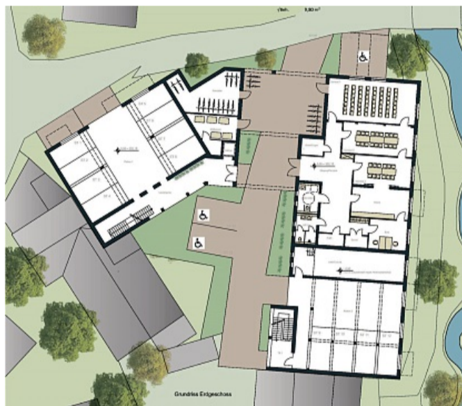
Im Erdgeschoss werden Gemeinschaftsräume untergebracht, die beiden Gebäudeteile werden im ersten und zweiten Obergeschoss miteinander verbunden.
