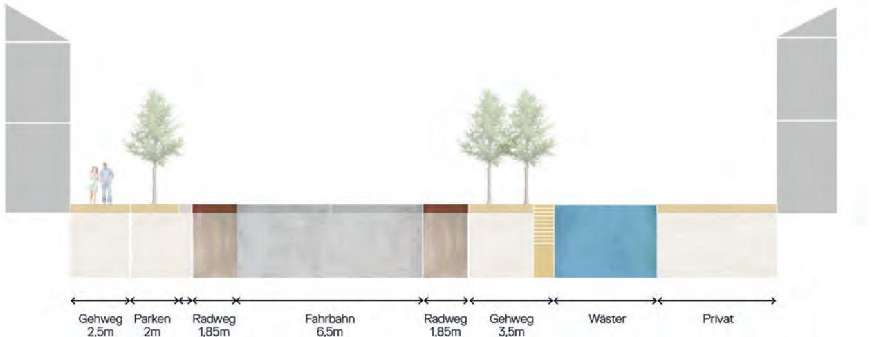
**ABB 049** Prinzipanschnitt Umbau Wästerboulevard
